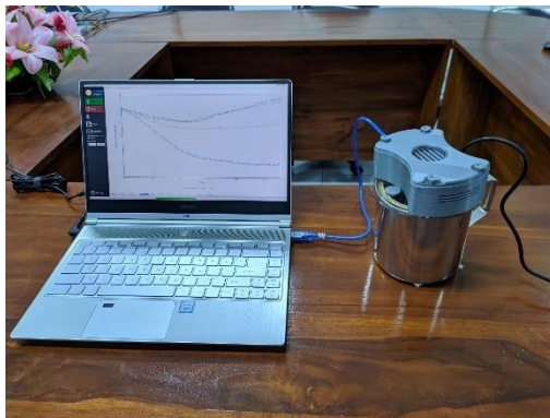
Gambar 8. Alat karakterisasi sensor gas berbasis QCM yang dikembangkan dan telah dikalibrasi dan dipatenkan, konsep eksperimennya
